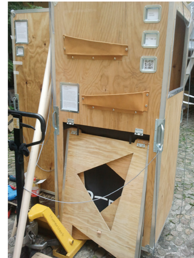
Klappböcke und Tischplatten sind im Inneren verstaubar. Innere Tischplatte dient auch als Verschlussklappe.
